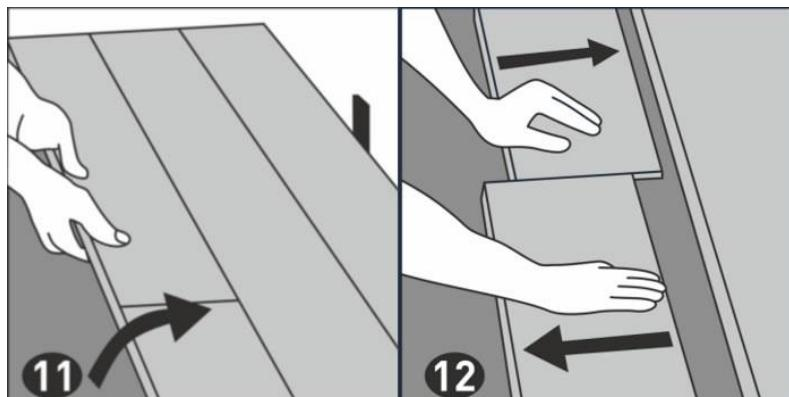
Разъедините весь ряд, приподняв его под небольшим углом. Оставив его на горизонтальной поверхности, плавно отсоедините торцевое замковое соединение, сдвигая их в разные стороны. Если ламели отсоединяются с некоторым усилием, вы можете сделать это, приподняв их на угол  $5^{\circ}$ , сдвигая в разных направлениях.
