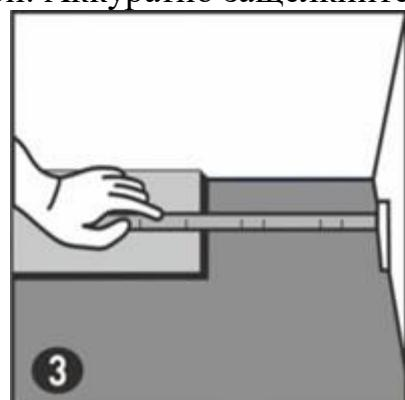
3. В конце первого ряда оставьте расширительный зазор с торца, равный зазору по периметру, и измерьте длину последней доски.
