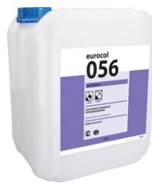
Готовая грунтовка глубокого проникновения. Применяется для подготовки впитывающих влагу, пористых оснований (бетонные и цементно-песчаные стяжки, цементно-известковые, известковые, гипсовые и ангидритные поверхности); обработки гипсокартона, цементно-стружечных плит, кирпича, ячеистых бетонов; нанесения нивелирующих масс, штукатурок, плиточных клеев, при обойных работах и покраске внутри и снаружи помещений. Морозостойкая.
